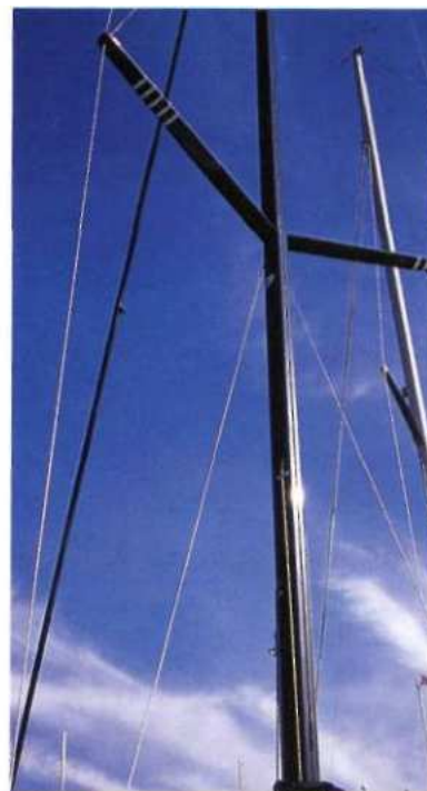
Мачты из углеродных волокон в основном используются на гоночных яхтах
