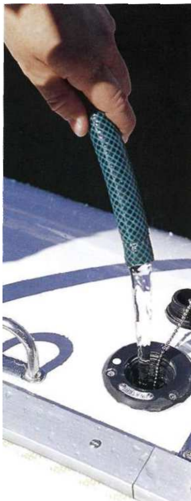
Баки для воды обычно заполняются через отверстие, открывающееся на палубе
