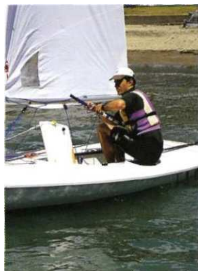
Направьте лодку курсом крутой бейдевинд, бейдевинд или галфвинд, соответственно закрепите паруса. После этого опустите шверт и руль
