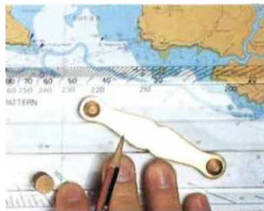
Нанесение местоположения: параллельная линейка размещается по линии широты на карте, а потом перемещается параллельно АО нужного места
