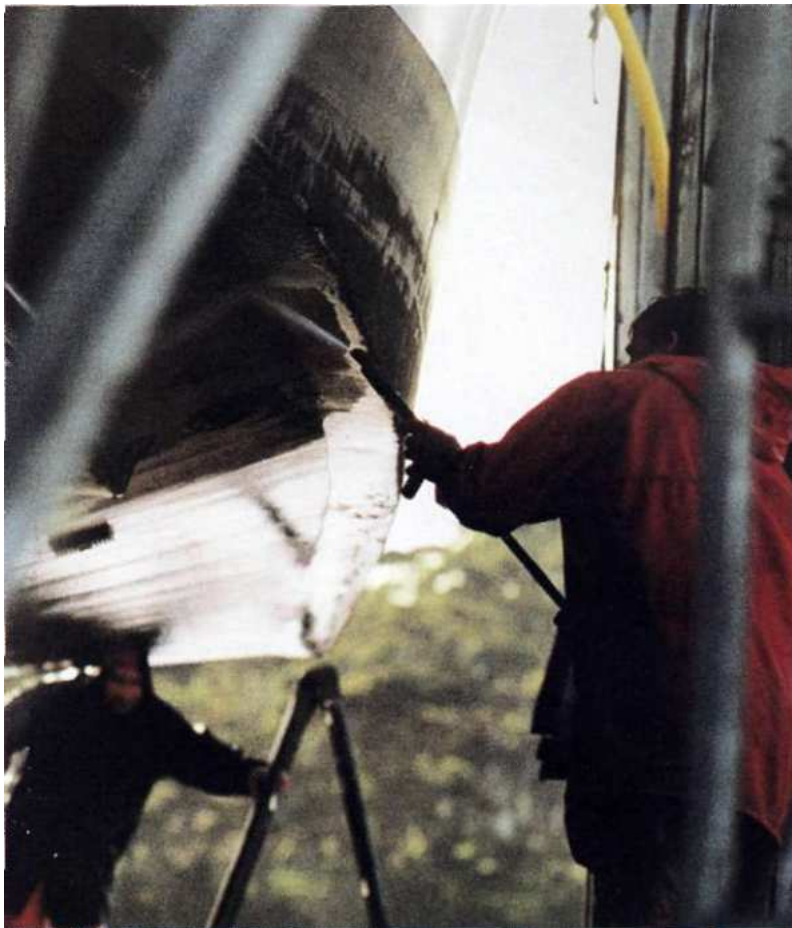
Для очистки ПОНАВОДНОЙ поверхности корпуса используется аппарат высокого давления
