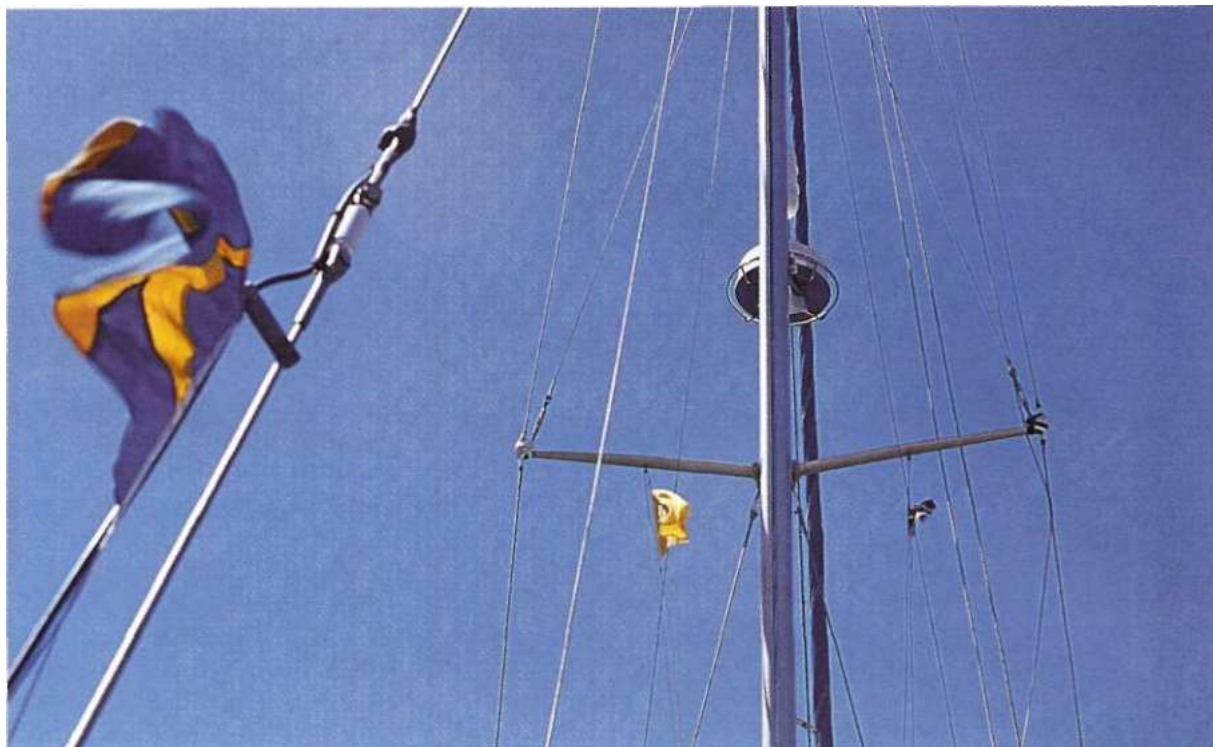
Оснастка (общее название для мачты, такелажа и парусов) - источник энергии парусного судна
