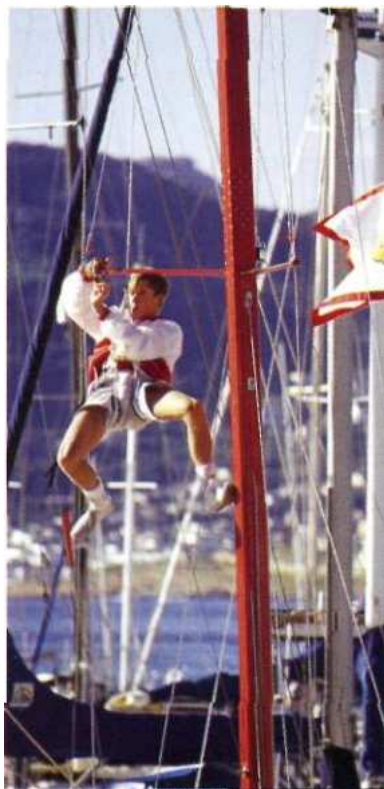
Веселка для подъема на мачту облегчает работу со стоячим такелажем
