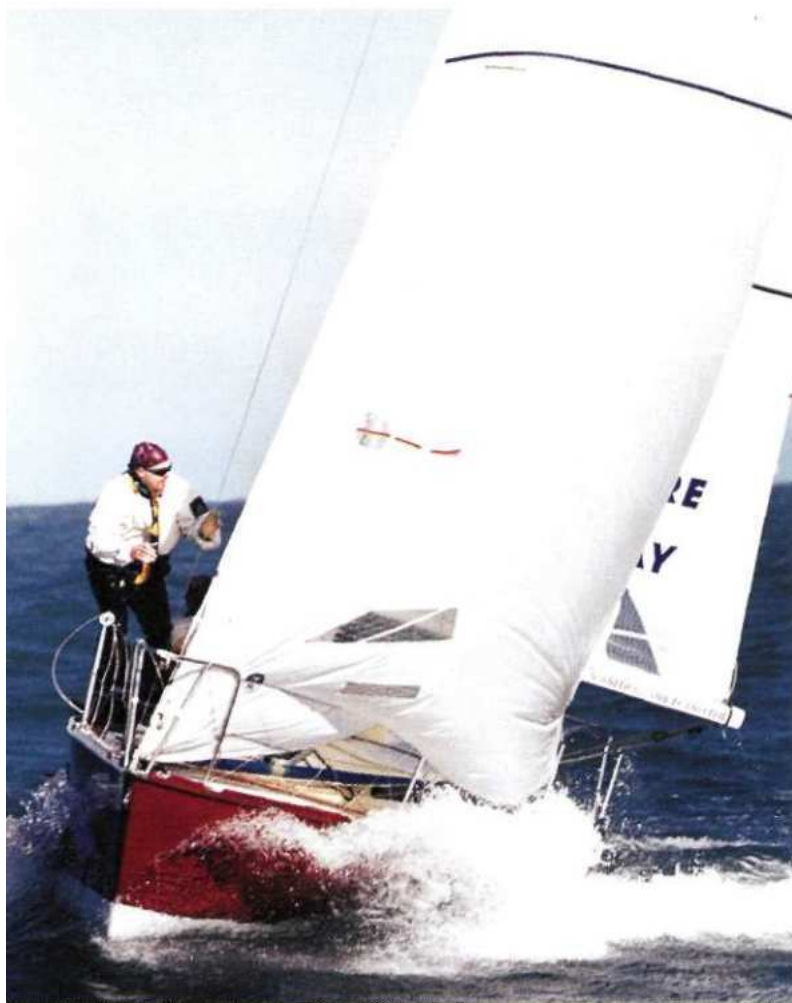
Когда выпеллы, или «колдунчики», находятся в горизонтальном положении, яхта идет под оптимальным углом к ветру. «Колдунчики» обычно помещают за передней шкаториной паруса
