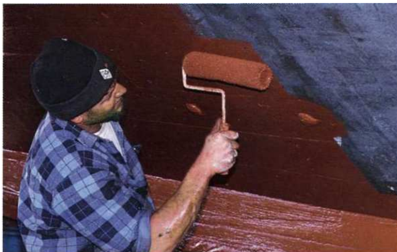
Полготовка поверхности с помощью наждачной бумаги и нанесение защитного слоя помогут пролить срок службы и улучшить внешний вид деревянного корпуса
