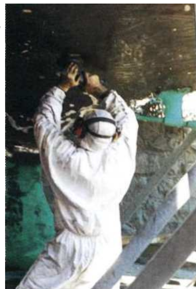
Полготовка поверхности с помощью наждачной бумаги и нанесение защитного слоя помогут пролить срок службы и улучшить внешний вид деревянного корпуса
