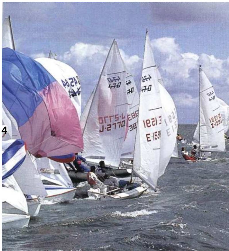
Попутный ветер воодушевляет, в некоторых классах плоскодонки несут специальные паруса для попутного ветра - спинакеры и генакеры, чтобы гонка прошла быстрее и красивее
