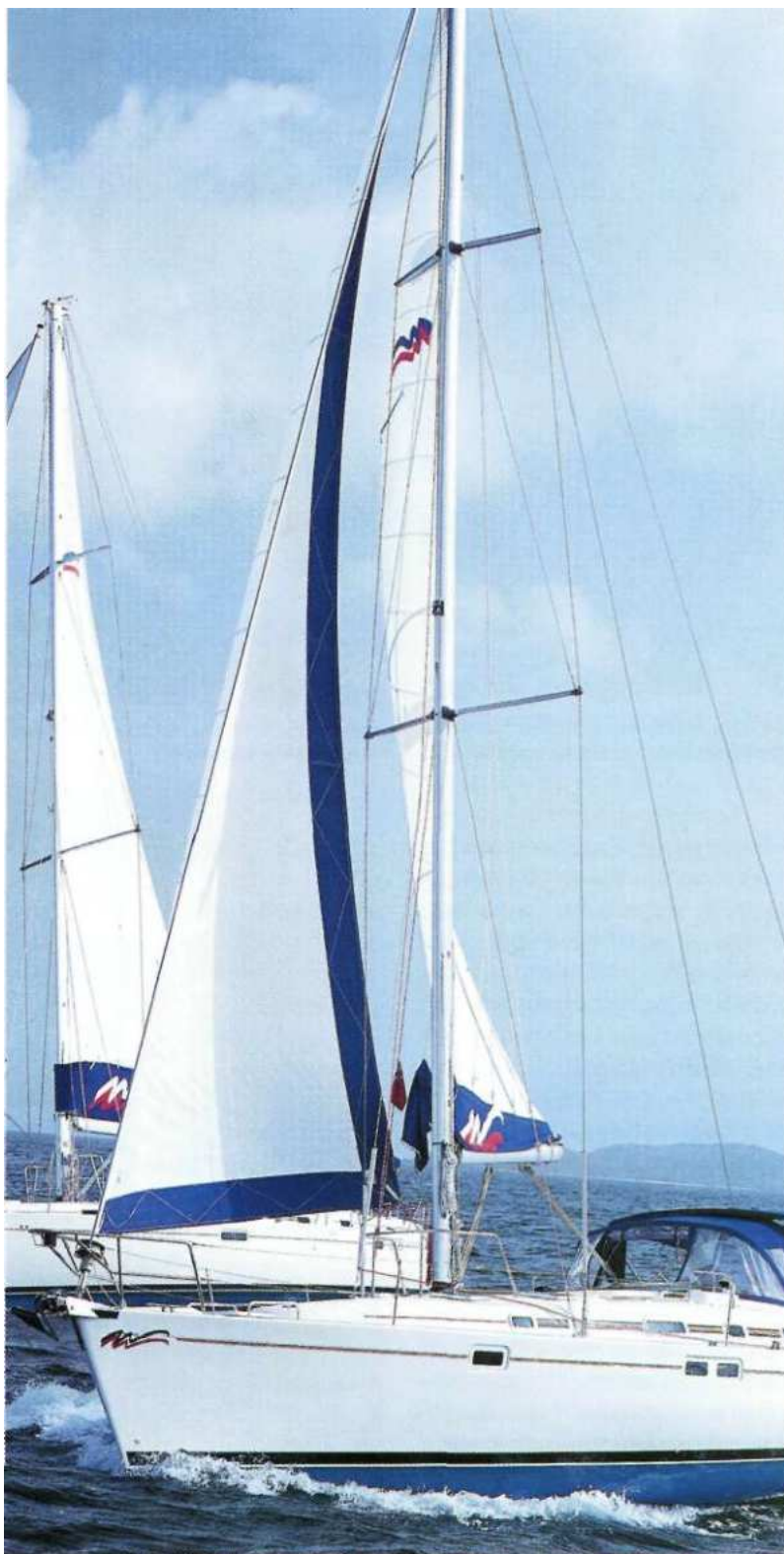
Мачта, рангоут и такелаж померзживают паруса и позволяют установить их соответственно ветру
