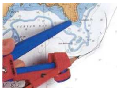
Дуга вычерчивается циркулем, его ножка ставится в самую крайнюю точку опасного места. Яхта не должна двигаться внутри этой дуги
