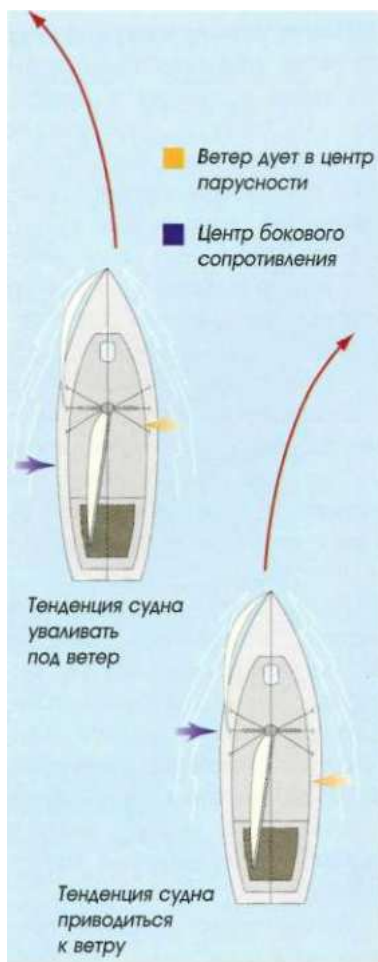
Равновесие достигается в результате взаимодействия центра парусности и центра бокового сопротивления
