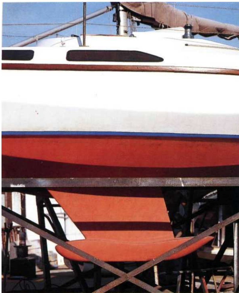
Когда лодку поднимают из воды для обслуживания, ее нужно устанавливать в люльке или на подпорках
