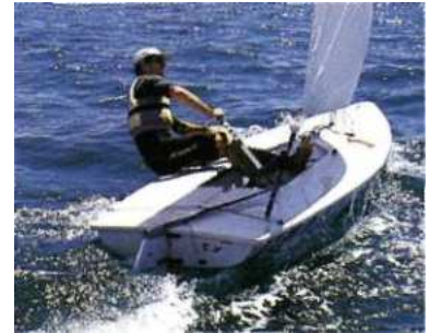
Отверните румпель от себя, чтобы развернуть яхту носом прямо против ветра
