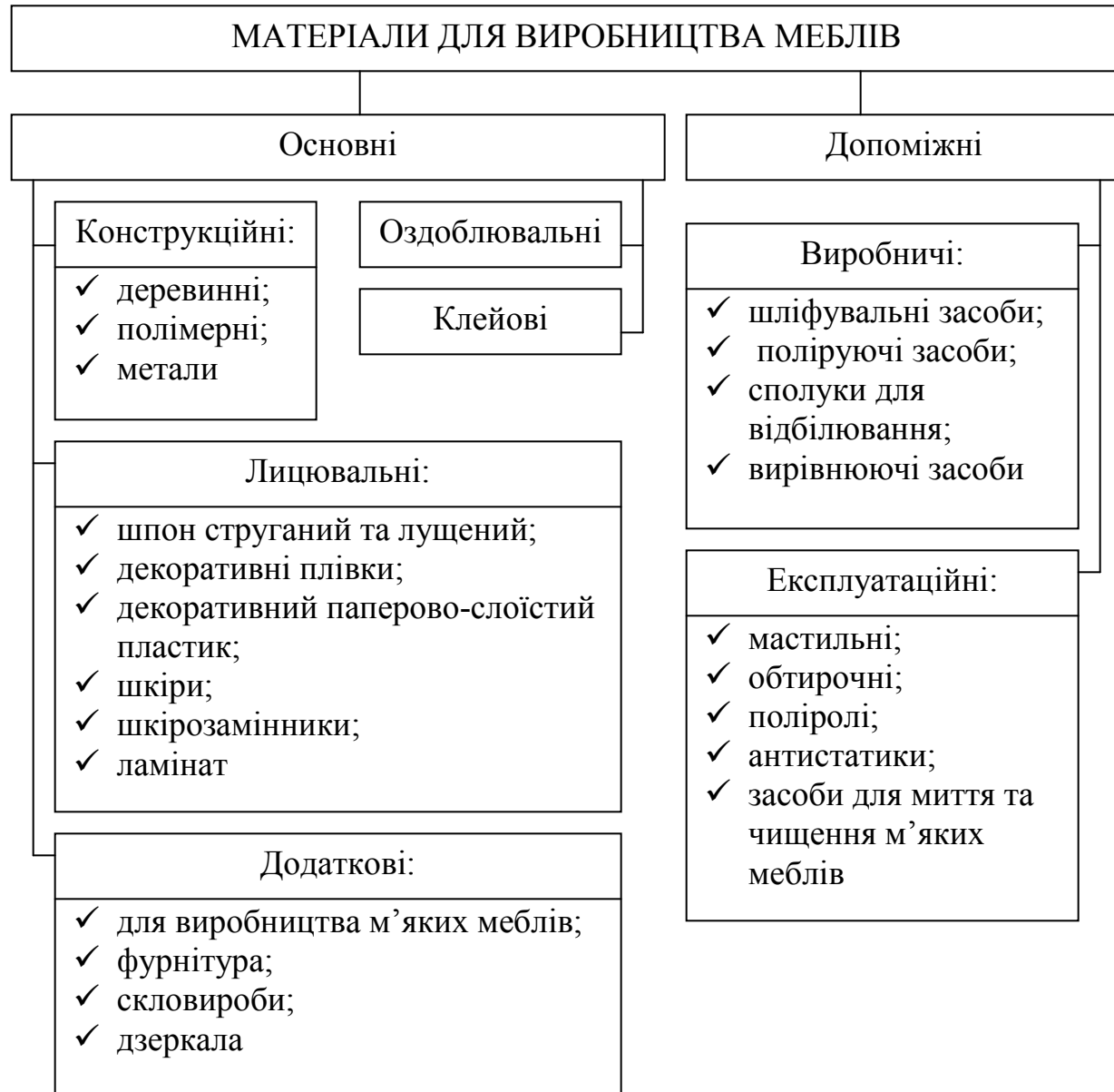
Рисунок 2.5 – Класифікація матеріалів для виробництва меблів
