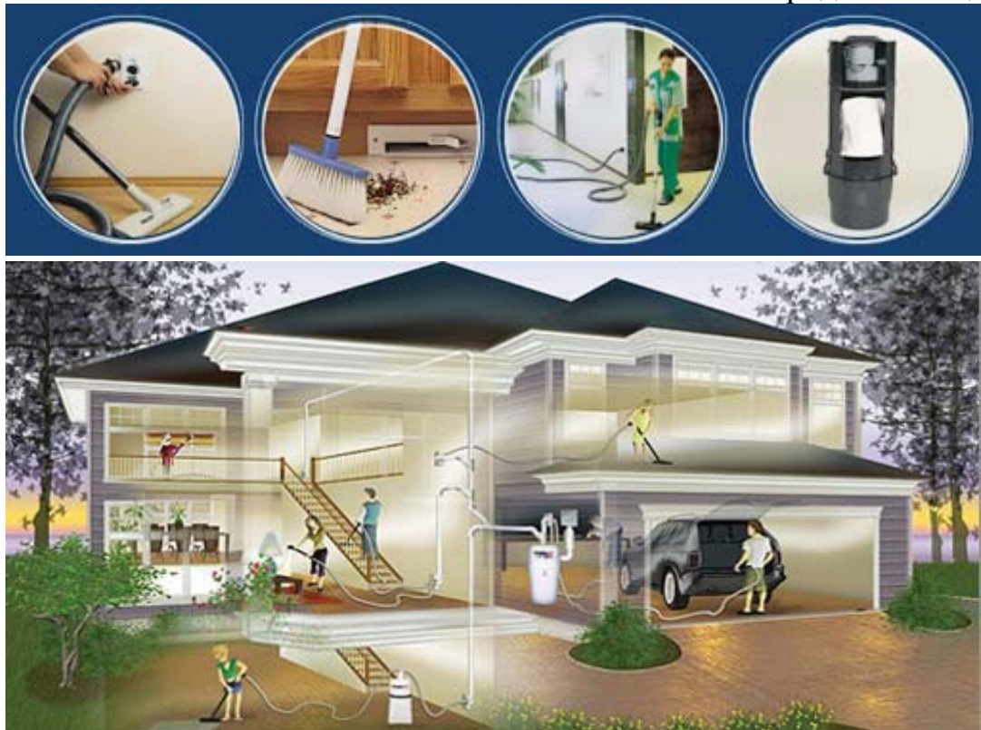
Рисунок 5 – Система центрального пиловидалення
