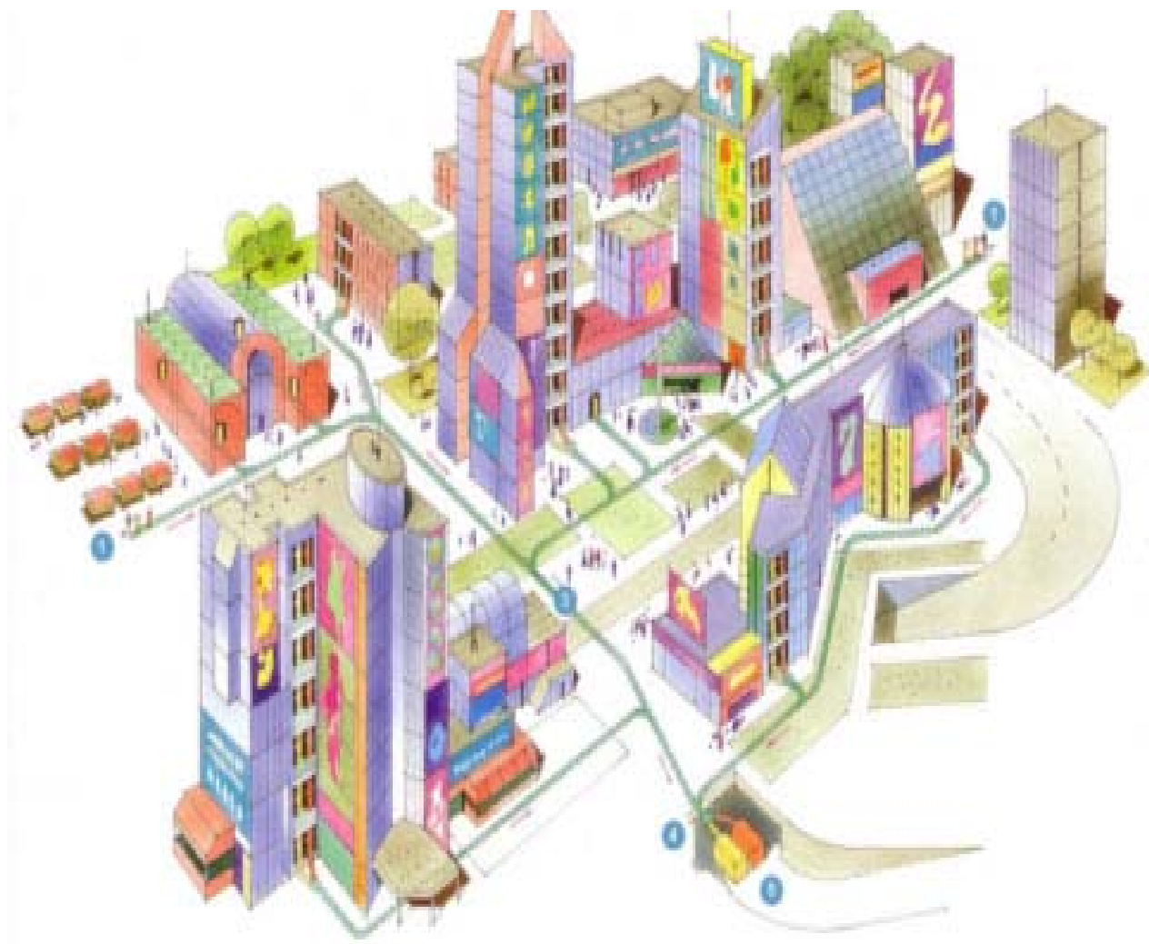
Рисунок 7 – Пневматична система транспортування біовідходів
