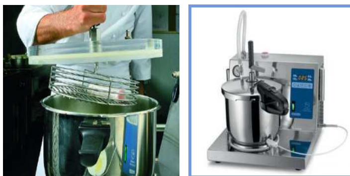
Рис. 2.16. Вакуумний маринатор Cookvac
